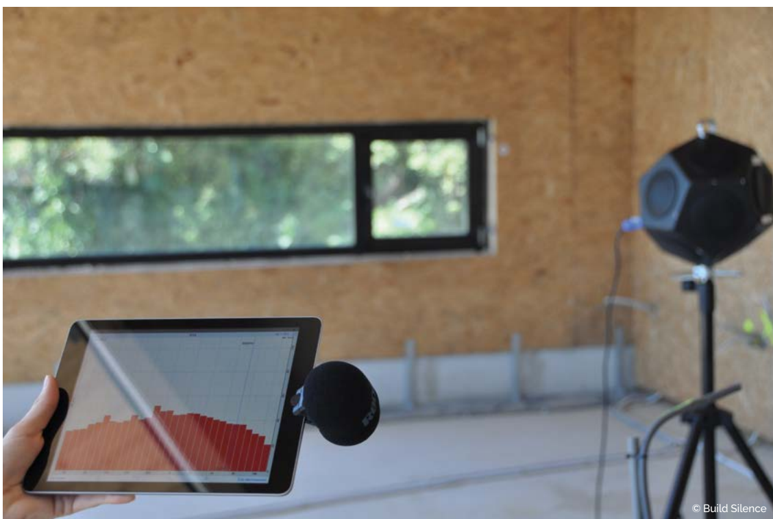
Photo 1 : Mesure sur site du spectre du niveau de pression acoustique en bandes de tiers d'octave.
