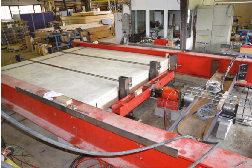
12 | Cyclische horizontale belastingsproef op een hout-betonvloer.
