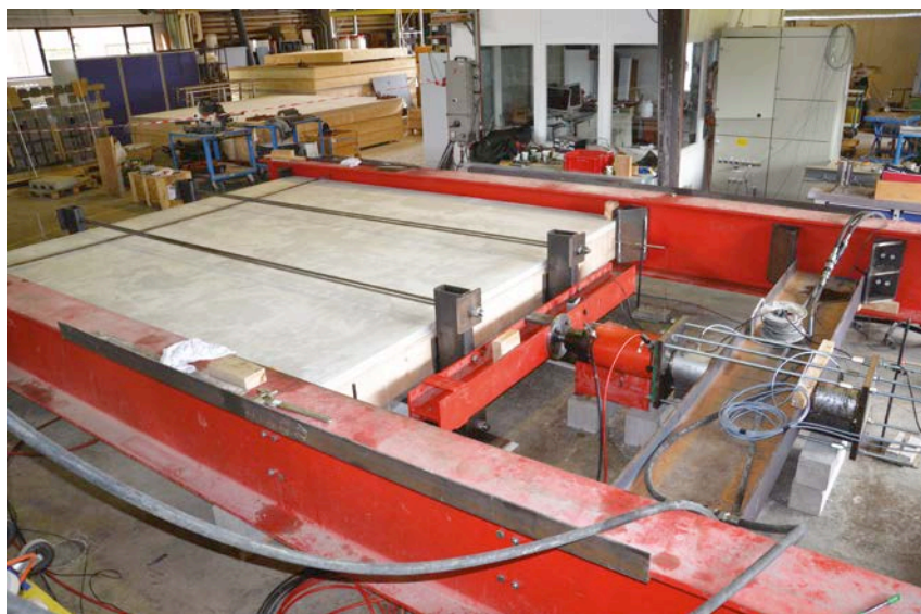
12 | Essai de chargement cyclique horizontal sur un plancher en bois-béton.
